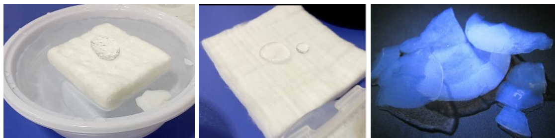
شکل ۲- عایق‌های گرانولی و بلنکت هواژل نانومتخلخل فوق آب‌گریز (با اجازه از شرکت پاکان آتیه نانودانش)
