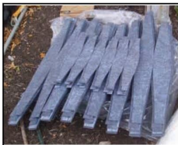
شکل ۶- قابلیت برشکاری عایق‌های هواژل
