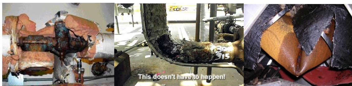
شکل ۹- نمونه هایی از اثرات خوردگی زیر سطح عایق
